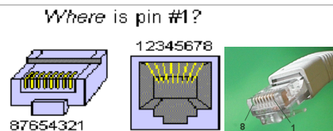
Fig. 4.4 Cavo UTP5 con connettori RJ45
